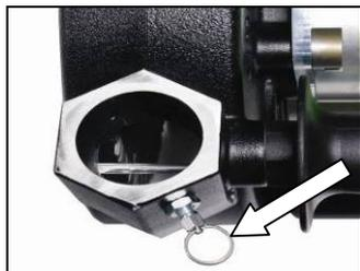
Le tuyau d'aspiration peut être verrouillé empêcher un glissement à l'aide de la fixation du tuyau.
