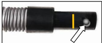
Percez à 13mm de cette marque (trait) un trou d'un diamètre de 6 mm dans l'embout.
